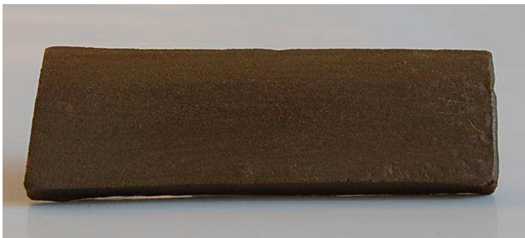
Figura 3.15 - Amostra do corpo de prova na forma de placa cerâmica para revestimento de alvenarias, após a secagem e antes da sinterização.
