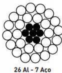
Figura 20: Construção cabo IBIS 397,5 MCM
