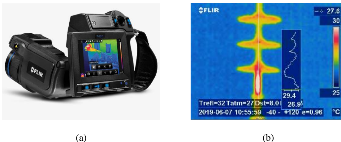
Figura 6: (a) Câmera termográfica T620 FLIR e (b) imagem termográfica de um isolador polimérico de 138 kV.
