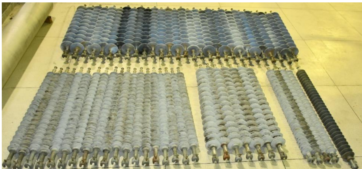
Figura 17: Fotografia dos isoladores poliméricos fornecidos pela Chesf.
