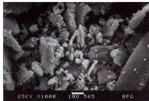
Figura 2.6 - Microscopia eletrônica de varredura de argila (1.000X)
