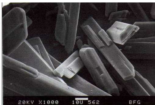
Figura 2.7 - Microscopia eletrônica de varredura de cristais de sulfato de cálcio hidratado (1.000X)
