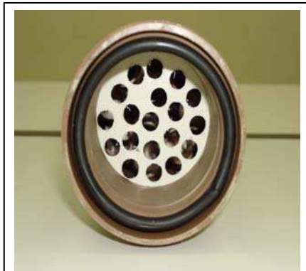
Figura 3.9 – Vista frontal do dispersor mostrando os orifícios de entrada e o anel de vedação.
