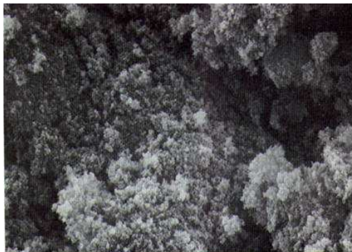
Figura 2.5 - Microscopia eletrônica de varredura de sílica (5.000X)
