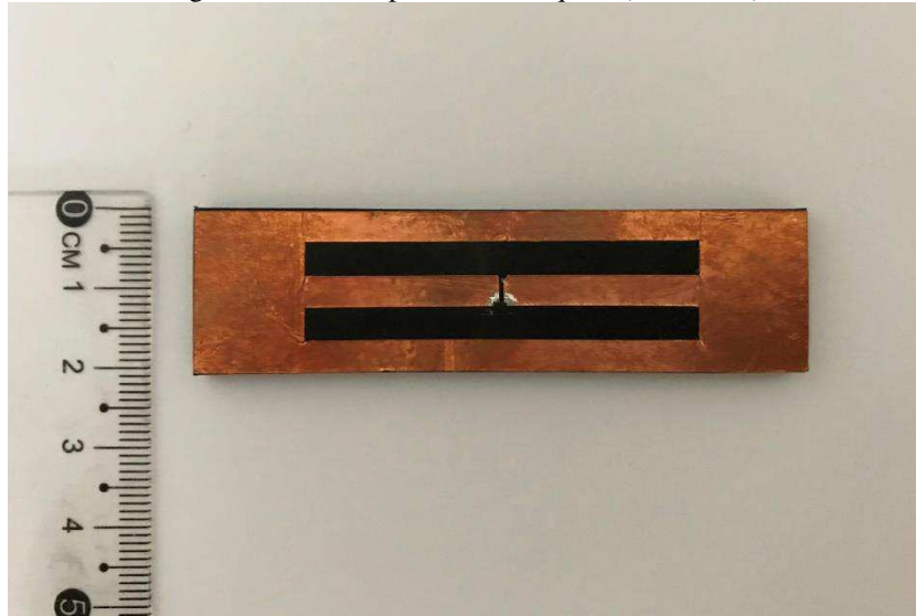
Figura 18 – Protótipo final da etiqueta ( b = 20\text{mm} ).
