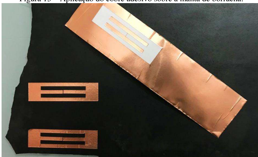
Figura 15 – Aplicação do cobre adesivo sobre a manta de borracha.
