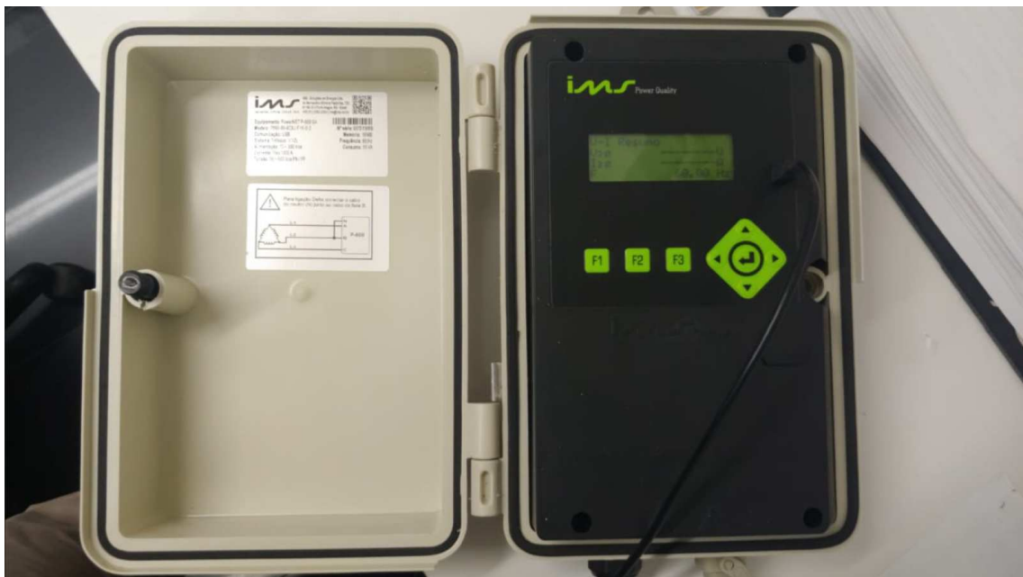
Figura 3: Analisador de Energia IMS PowerNET P-600 G4 aberto. Autoria própria.
