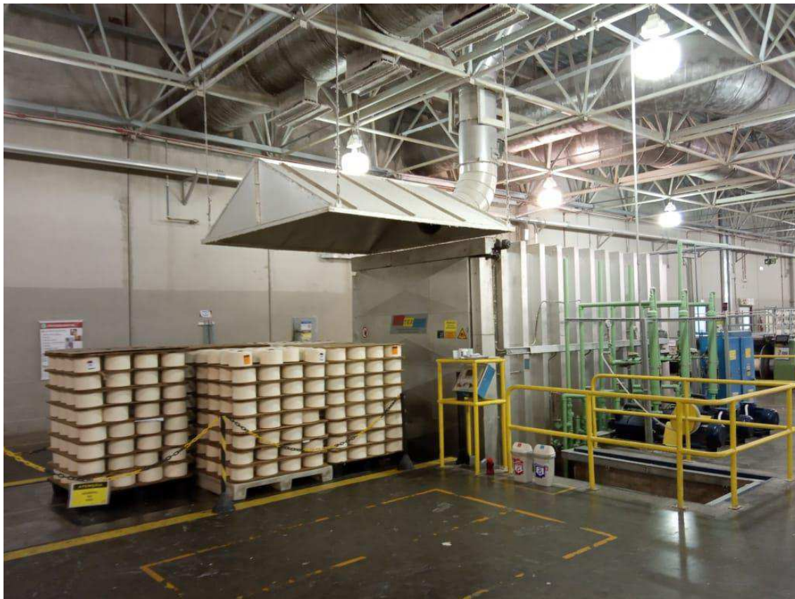
FIGURA 3 – IMAGEM DA MÁQUINA DE CONDICIONAMENTO DE FIOS A VÁCUO.
