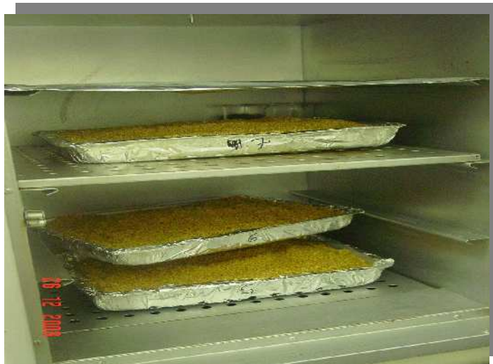
Figura 16. Fermentação semi-sólida do farelo de algaroba na estufa sem circulação
