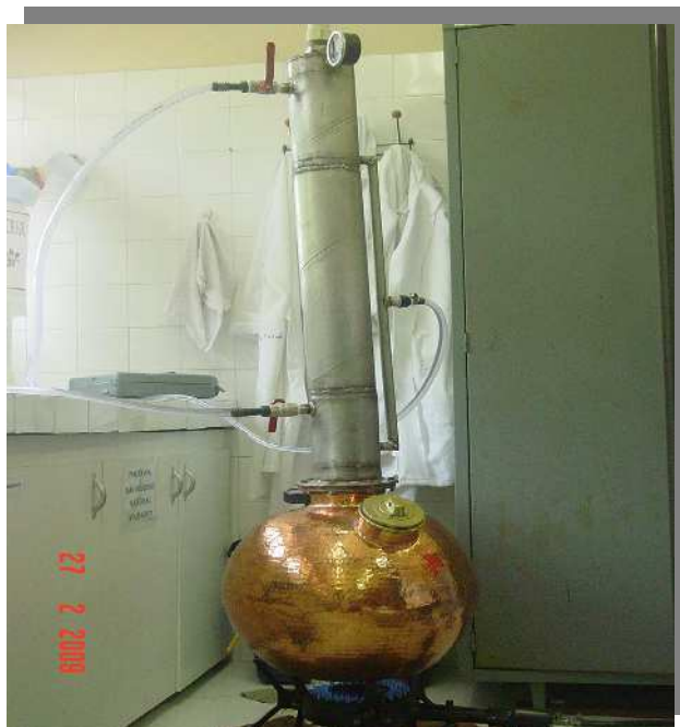
Figura 13. Destilador de cobre adaptado para produção de etanol
