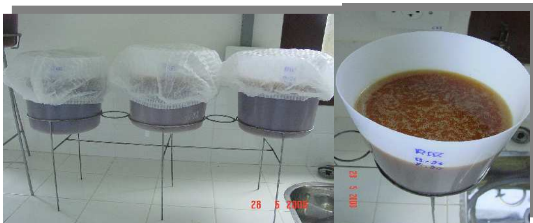
Figura 7. Processo de fermentação alcoólica das vagens de algaroba, através da levedura Saccharomyces cerevisiae
