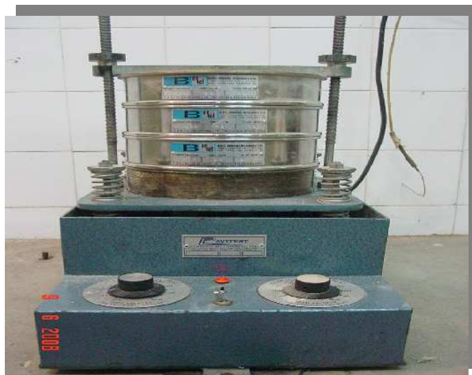
Figura 19. Peneiramento dos resíduos das vagem de algaroba
