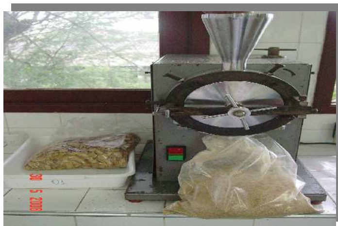
Figura 18. Moagem dos resíduos das vagem de algaroba
