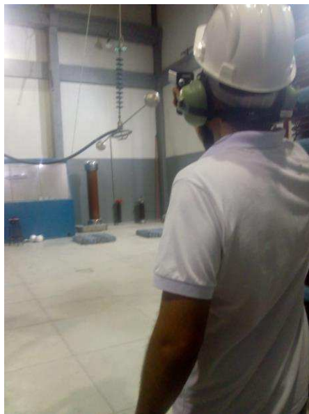
Figura 12 – Utilização do detector de ruído ultrassônico para extração de parâmetros de áudio.
