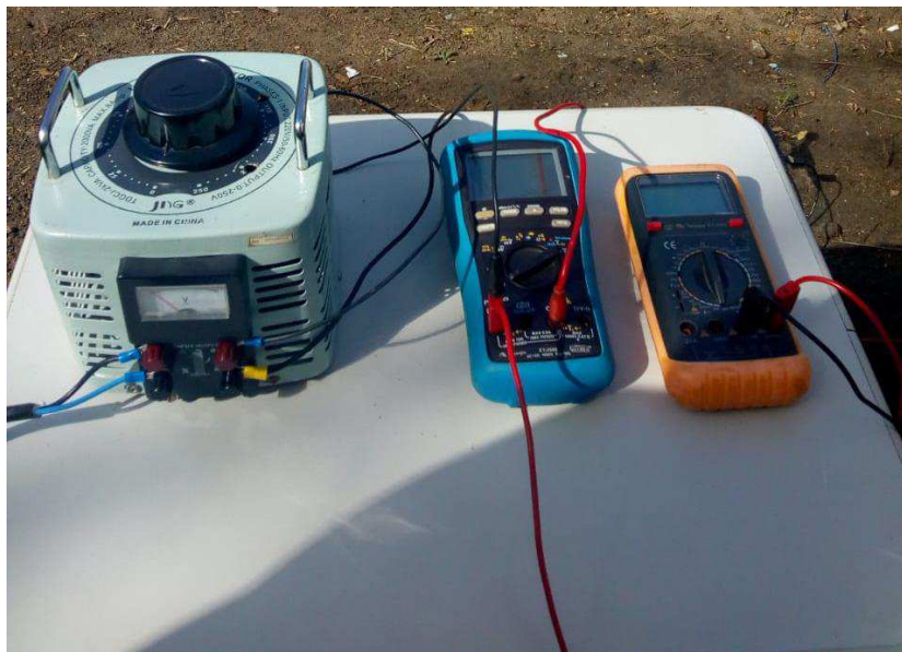
Figura 18 – Arranjo montado para injeção de corrente com VARIAC.
