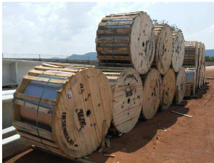
Figura 12: Bobinas cabos condutores
