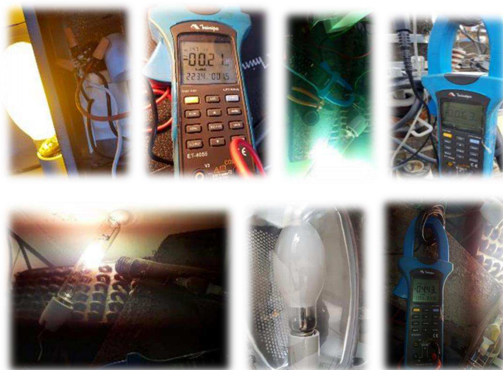
Figura 7: Alicate Wattímetro durante as medições.
