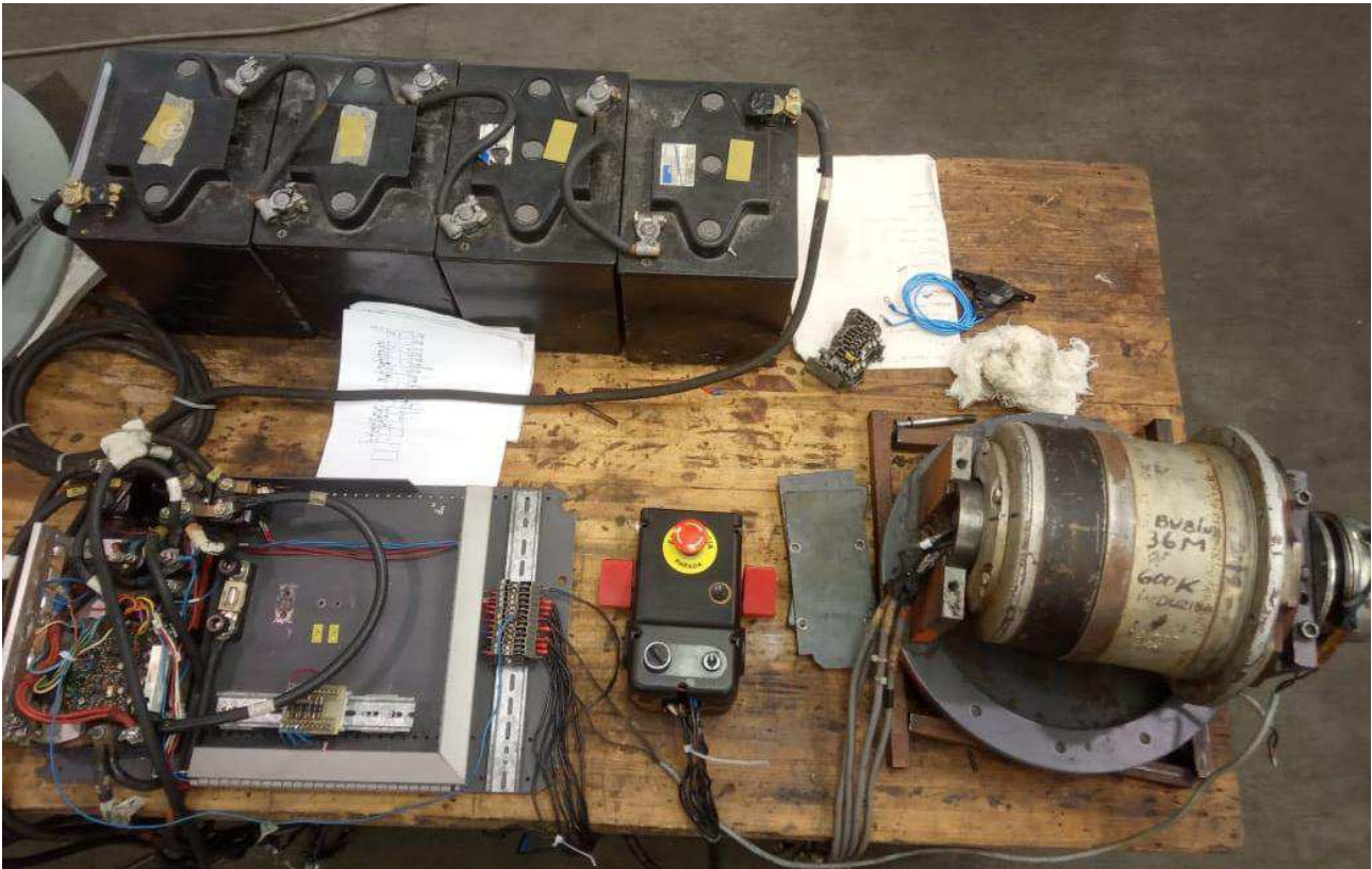
Figura 5 – Bancada de desenvolvimento do carro plataforma elétrico com peças reaproveitadas.
