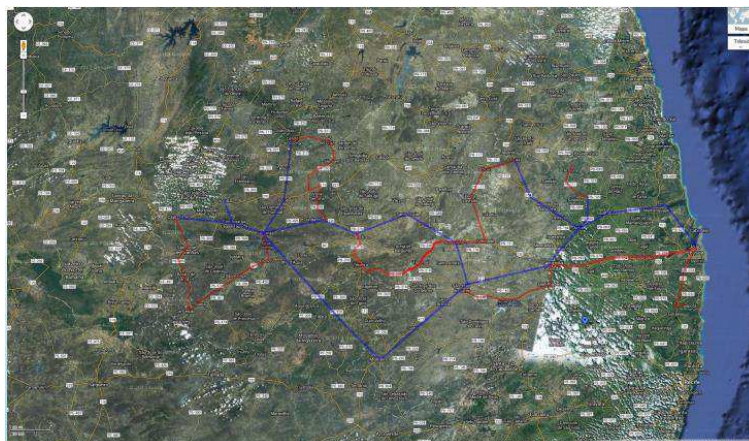
Figura 8: Distribuição da malha ótica projeto REPAD
