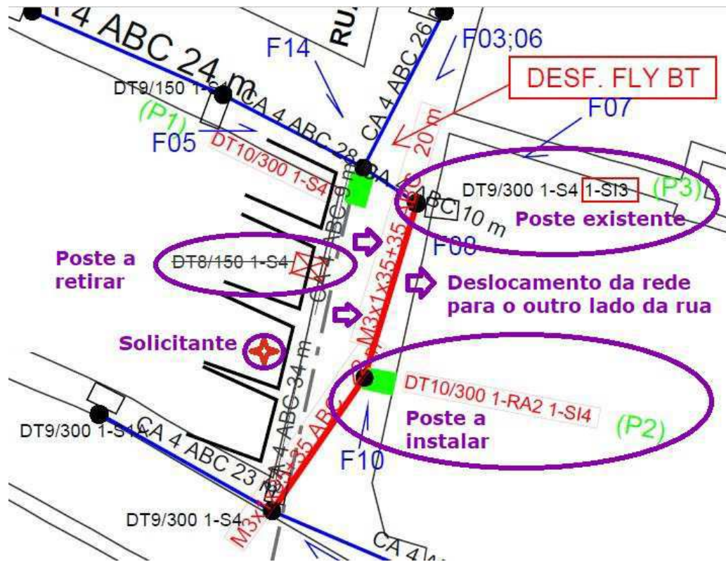
Figura 34 – Detalhe do projeto de melhoria de rede para atender a solicitação do cliente.
