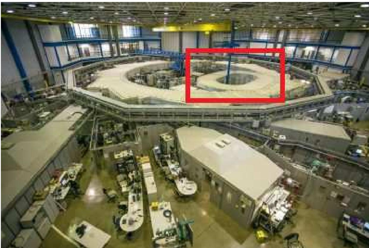
Figura 4.3: Acelerador de Partículas de segunda Geração do LNSL. Destacado em vermelho está o booster.
