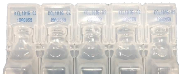
Figura 8: Codificação do produto impresso pela datadora Markem.Imaje série 9400. Fonte: Própria. (2019)
