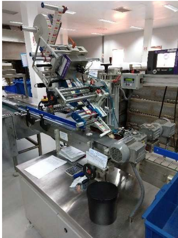
Figura 11: Rotuladores Lineares P.E. LATINA instaladas na Farmace. Fonte: Própria. (2019)
