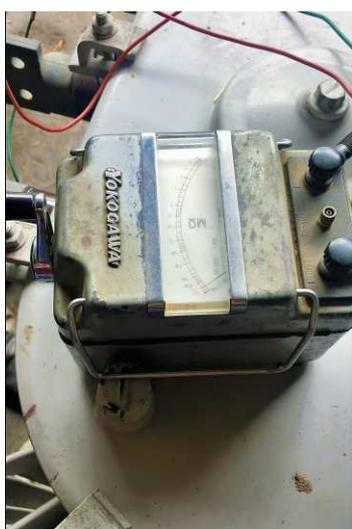
(a) Megômetro utilizado para medir Resistência de Isolamento DC.
