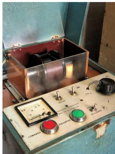
(b) Ensaio de Rigidez Dielétrica com amostra de óleo isolante.
