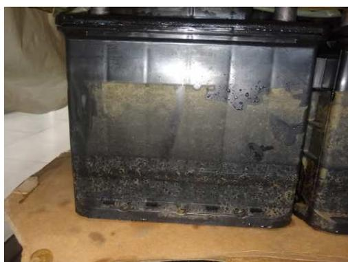
Figura 33 – Bateria Manchada por Sólidos em Suspensão
