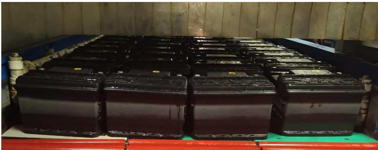
Figura 30 – Baterias manchadas após o processo de formação. (Fonte: Própria Autora.)
