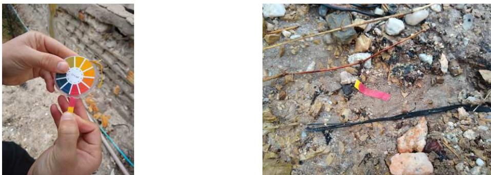
Figura 25 – Teste de pH do solo.
