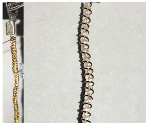
Figura 1 – Atuador de nylon bobinado envolto com fio de cobre.
