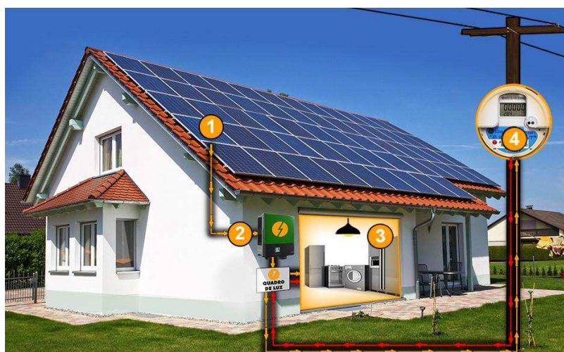
Figura 7 – Funcionamento do sistema fotovoltaico on-grid .
