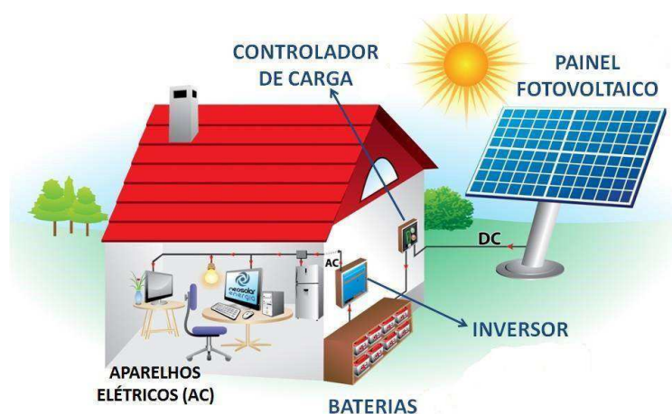
Figura 6 – Funcionamento de um sistema off-grid .
