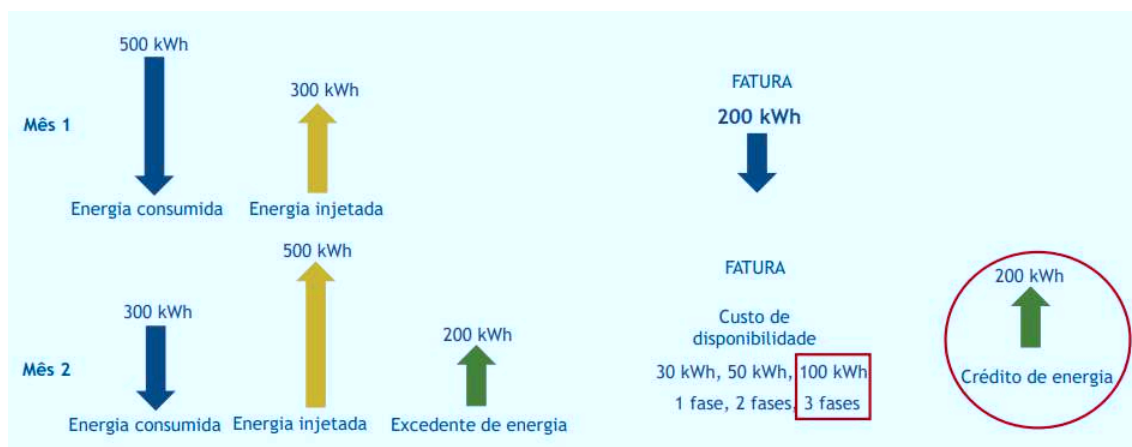
Figura 9 – Sistema de compensação de energia.
