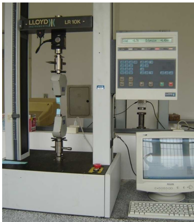
Figura 7. Máquina de ensaios mecânicos universais executando o ensaio de tração direta em fibra vegetal.
