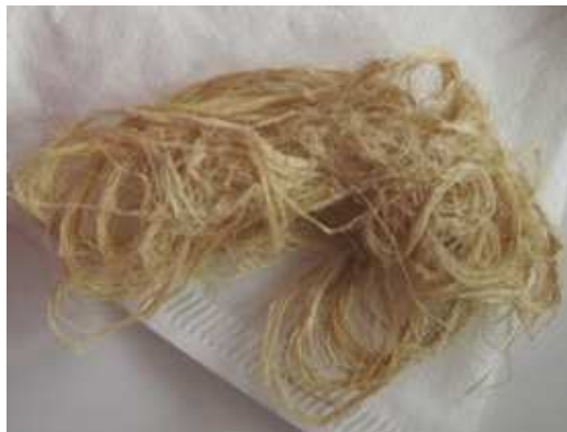
Figura 51. Aspecto das fibras de caroá não tratadas após 14 dias em solução de NaOH a 0,1\text{meq.L}^{-1} .
