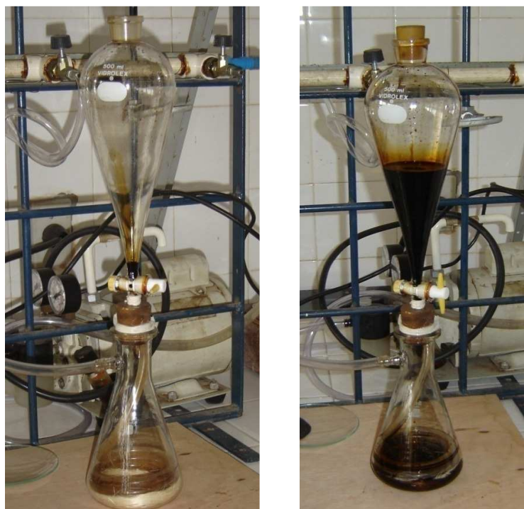
Figura 34. Sistema de impregnação das fibras. a) sob vácuo; b) liberação do licor pirolenhoso.
