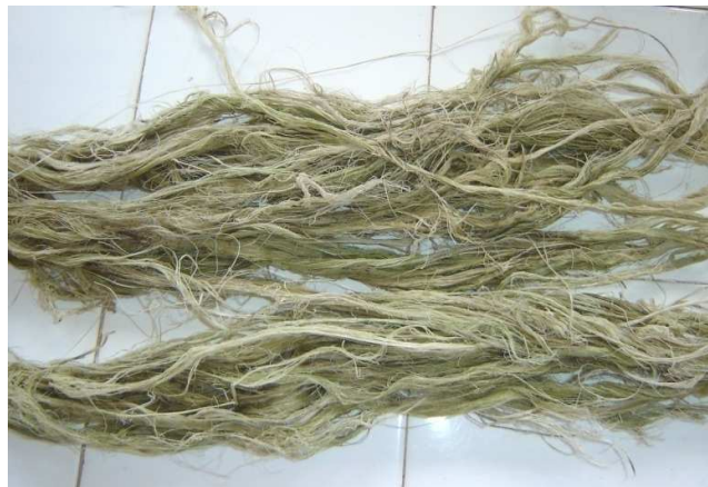
Figura 10. Fibras de caroá pré-beneficiadas por desfibramento mecânico.
