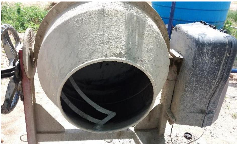
**Figura 2.** Betoneira utilizada na mistura do concreto.
