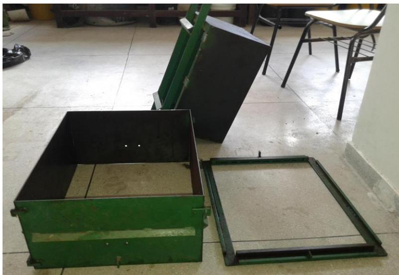
**Figura 7.** Fôrma de ninho pré-moldada.
