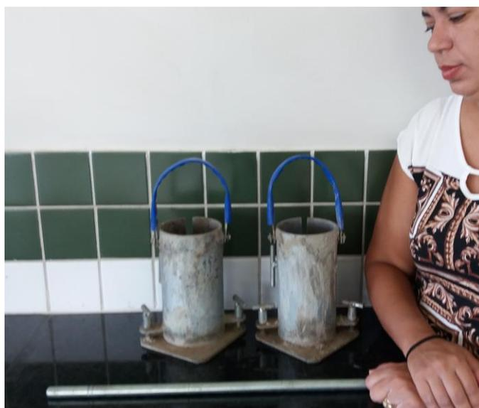
**Figura 4.** Corpos de prova cilíndricos
