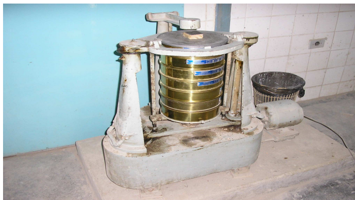
Figura 4.4 - Equipamento tipo RO-TAP, testing sieve shaker, com um conjunto de 6 peneiras (100, 120, 170, 200, 325 e 400) mesh, utilizado para a determinação da granulometria do pó de madeira
