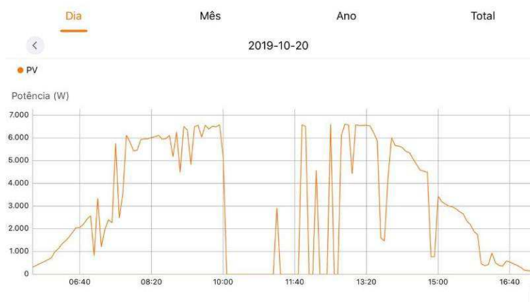
Figura 26 - Desligamento por elevação de tensão do inversor.
