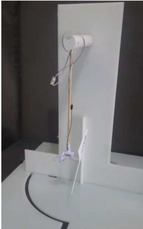
(a) Parte da frente do aeropêndulo, em estão presentes o eixo de rotação, a haste e conjunto {motor, engrenagens, hélices}.
