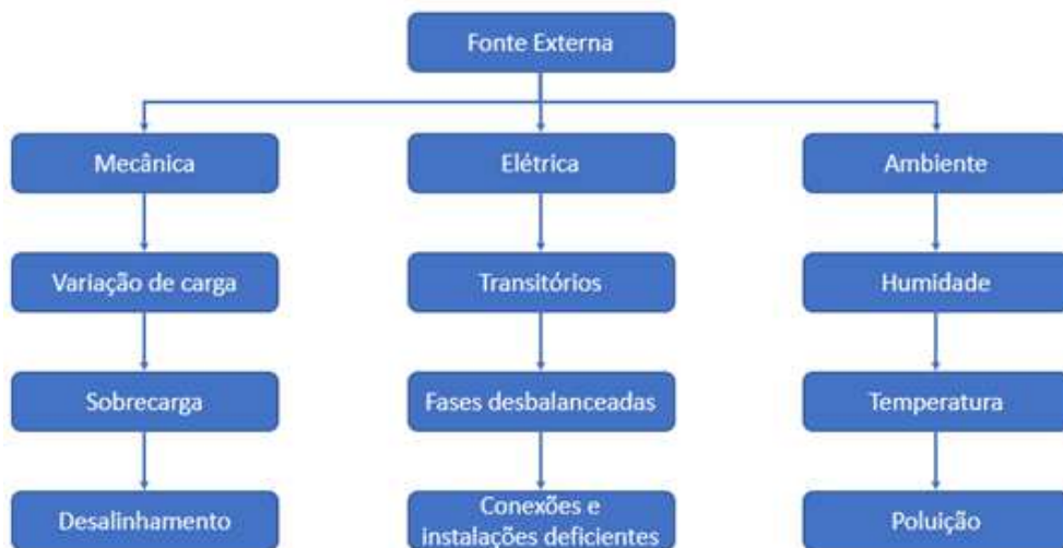
Figura 9: Fluxograma das fontes externas de falha do motor elétrico.
