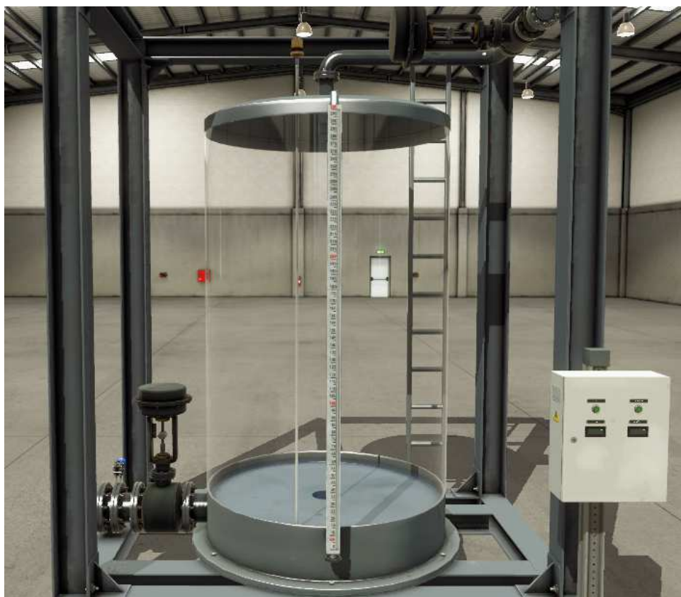
Figura 8 – Tanque de Nível.
