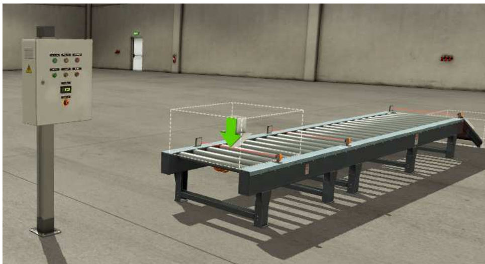
Figura 9 – Esteira com Contagem de Caixas.
