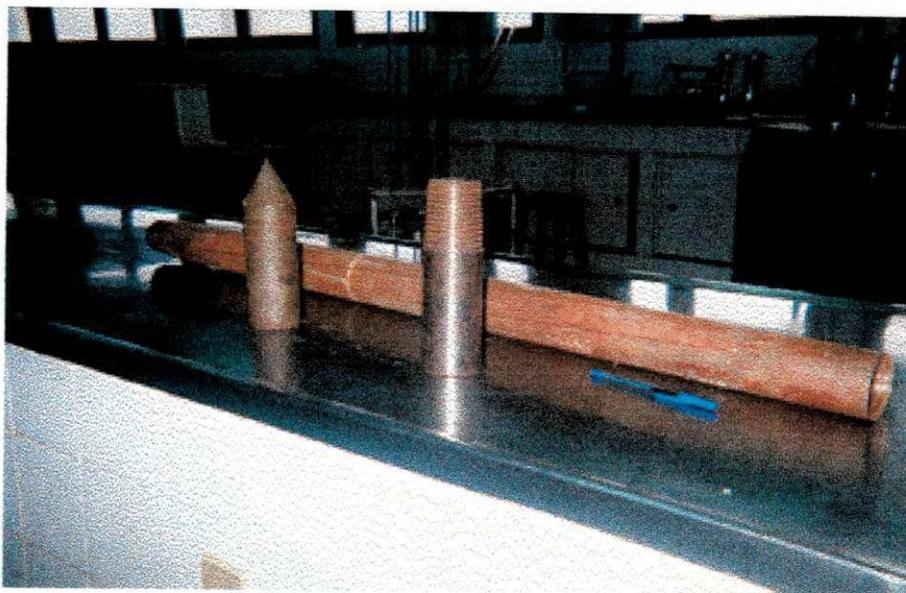
**Figura 3.9 – Revestimento da sonda (ponta e cabeça de bater) usado durante os ensaios feitos através da inserção direta ( cravação dinâmica).**
