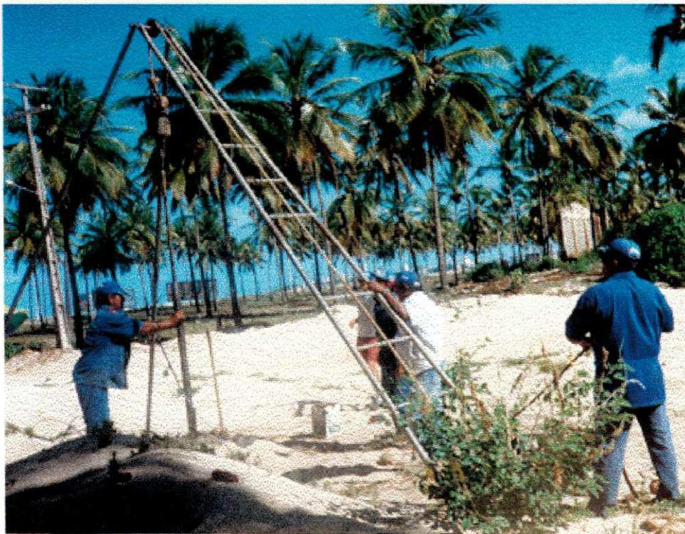
**Figura 3.12 – Equipamento de SPT adaptado para a cravação dinâmica.**
