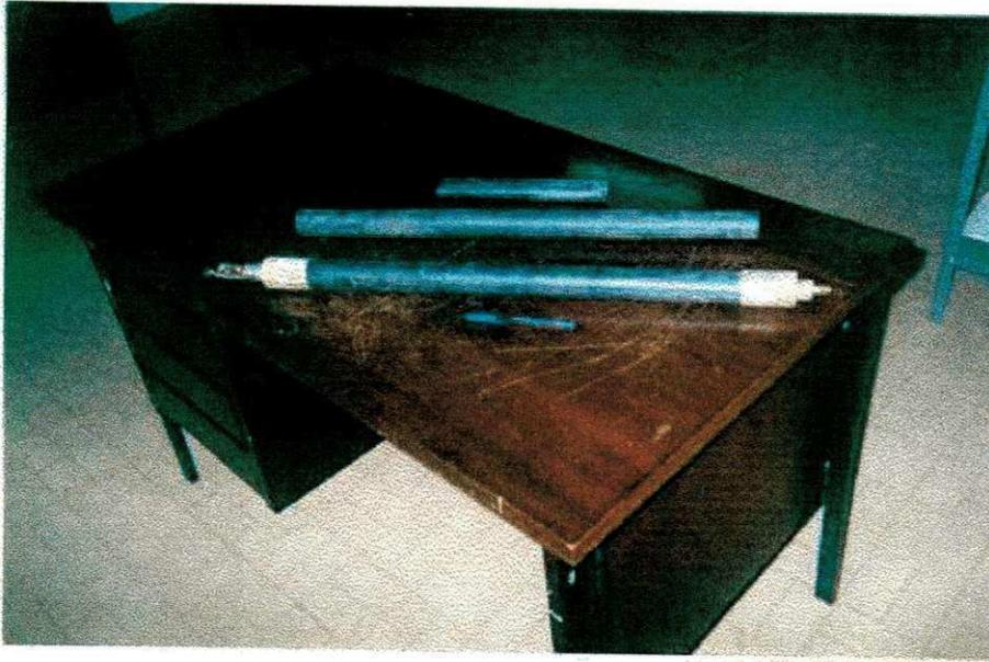
**Figura 3.8 – Sonda usada durante os ensaios de inserção direta.**
