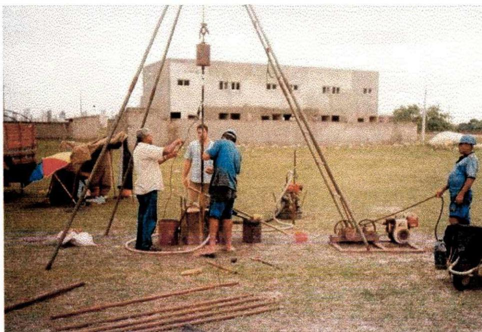
Figura 3.8 – Foto da composição básica da aparelhagem do SPT utilizada nas campanhas de ensaio.
