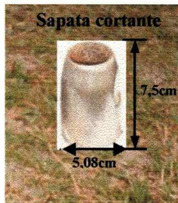
**Figura 3.11 – Foto da sapata cortante usada nas campanhas de ensaio.**
