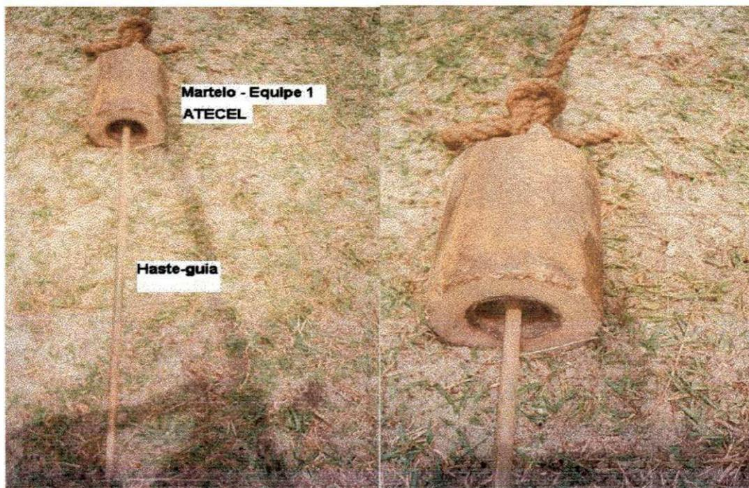
**Figura 3.9 – Ilustração do tipo de martelo utilizado nas campanhas de ensaio realizadas pela equipe da ATECEL.**
