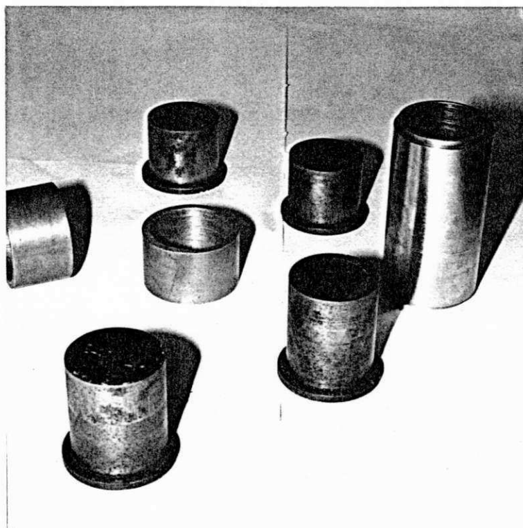
FIGURA III.8 - FOTOGRAFIA DO MOLDE DE COMPACTAÇÃO ESTÁTICA - ENSAIOS TRIAXIAIS
