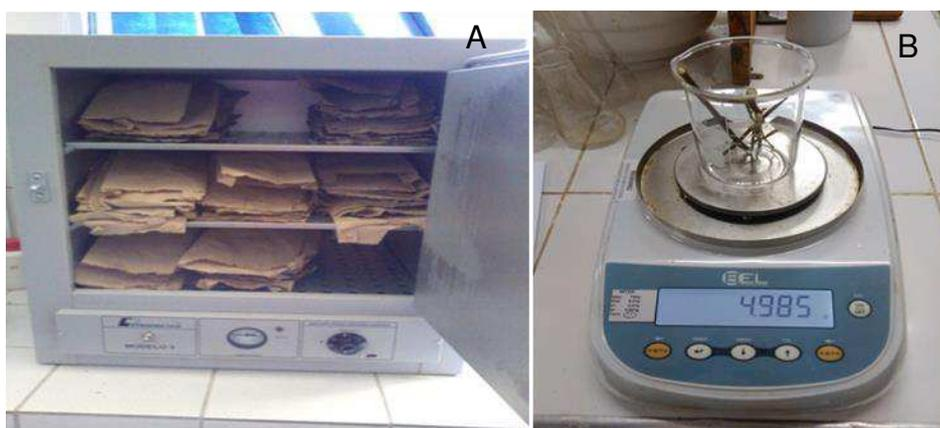
**Figura 3.** Material posto para secar em estufa de circulação de ar (A) e pesagem das fitomassas (B).
