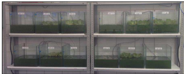
Figura 2: Aquários com efluente oriundo de um cultivo de tilápia tratado com diferentes densidades de p. stratiotes .
