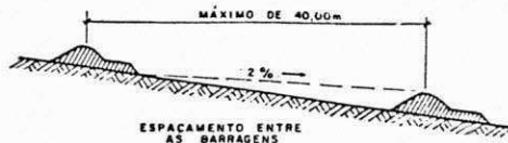
ESPAÇAMENTO ENTRE AS BARRAGENS
