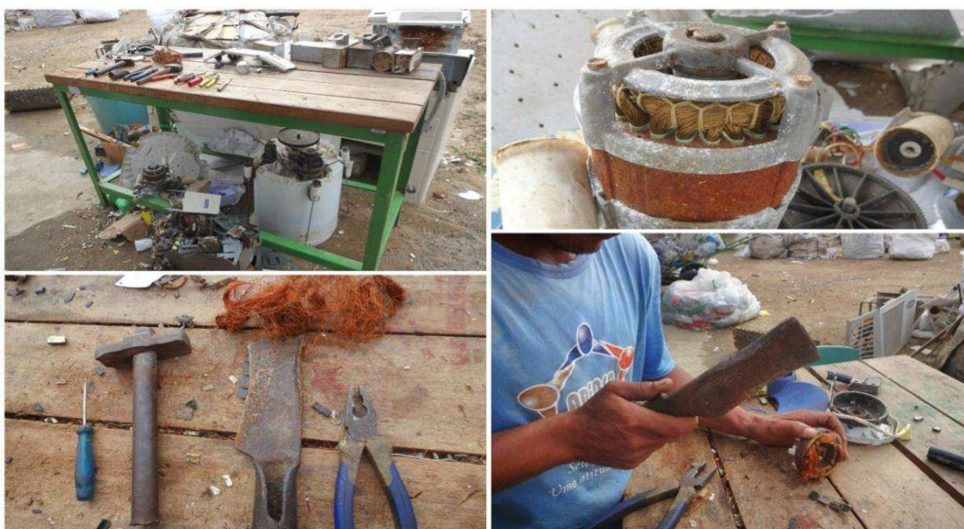
Figura 45. Desmanche de resíduos de equipamentos eletroeletrônicos para retirada do cobre pelos associados da ARENSA, Campina Grande, Estado da Paraíba, 2017. Fotos: Autoria própria.
