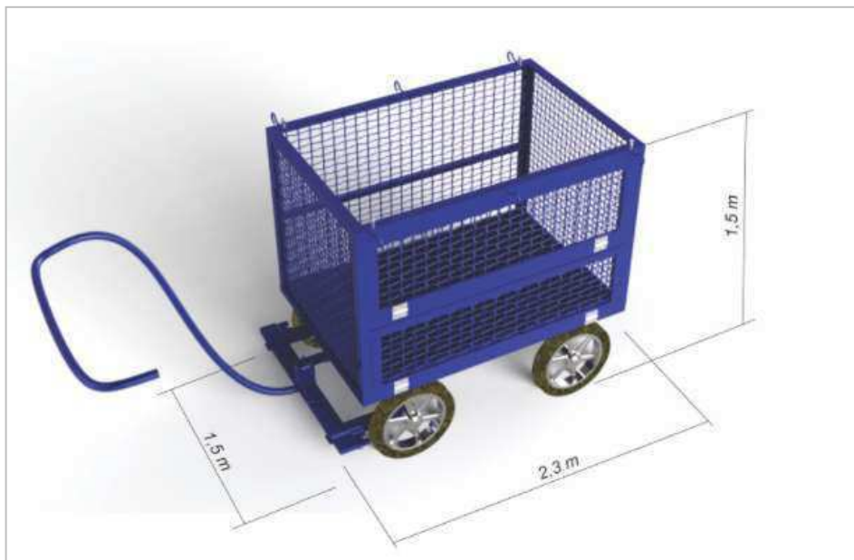
Figura 20. Transporte manual (C8) desenvolvido por Sousa (2018) atendendo aos Princípios da Tecnologia Social. Foto: Autoria de Sousa (2018).
