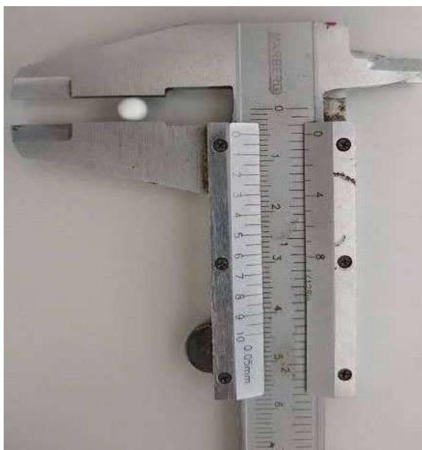
**Figura 14: Medida do diâmetro das esferas.**
