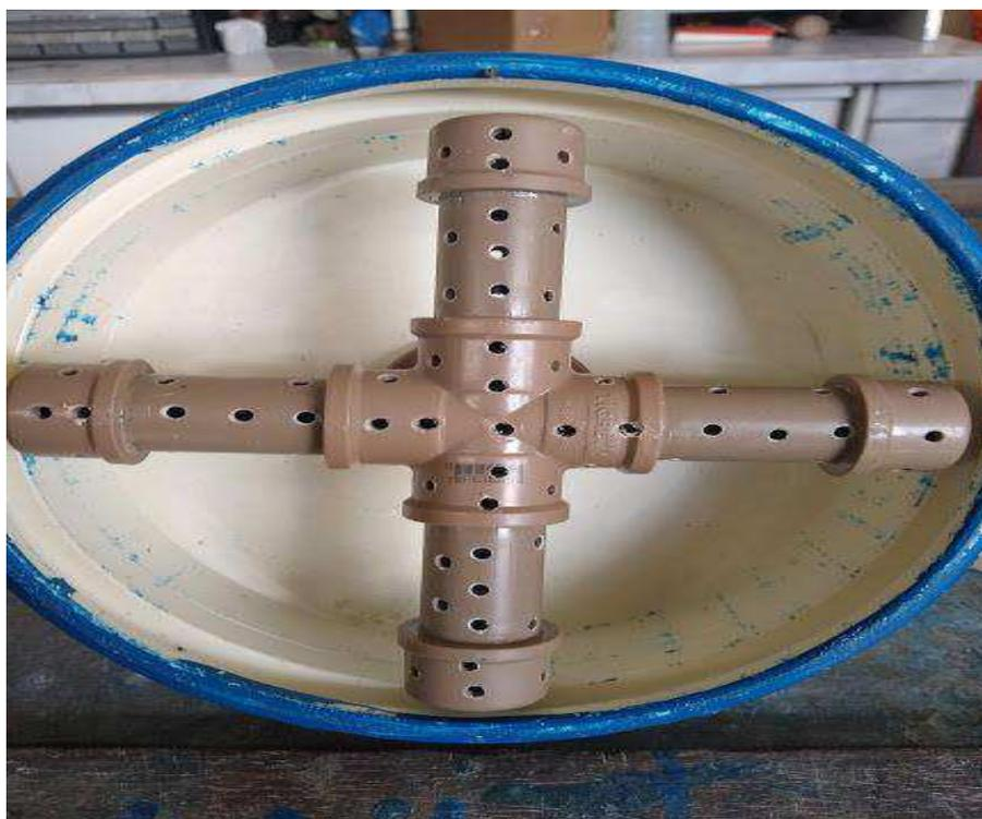
**Figura 20: Crepina para distribuição do efluente dentro do reator.**
