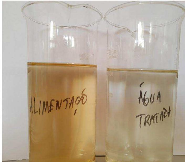
**Figura 52:** Comparação água da alimentação e tratada com esferas de PS de 5 mm.
