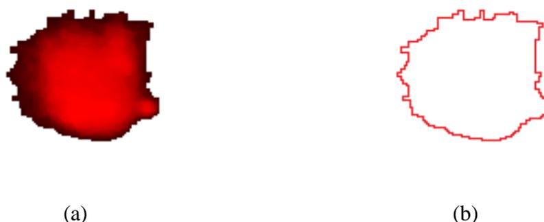
Depois de varrer toda a imagem e definir todos os píxeis de borda, faz-se uma nova varredura, utilizando um contador, obtendo dessa maneira o perímetro integralizado da manifestação UV em número de píxeis, conforme (4.5):
