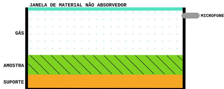
Figura 18 – Representação em corte transversal de uma câmara fotoacústica.
