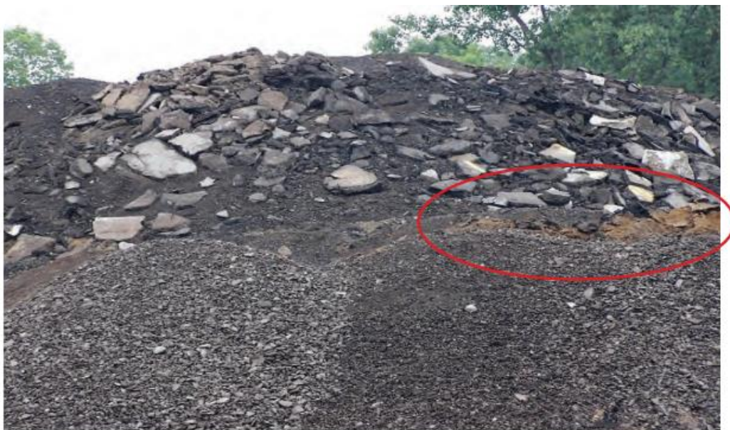
Figura 5 - Pilha de RAP de múltiplas origens contaminada por sujeira (círculo em vermelho)
