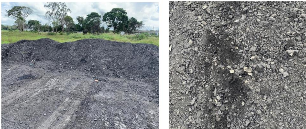
Figura 23 - Coleta de amostras de RAP: (a) Pilha de estocagem ao ar livre e (b) Aspecto visual do material fresado
