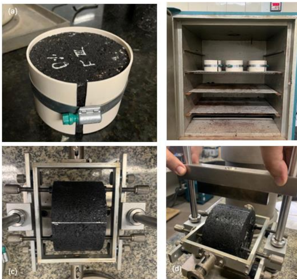
Figura 35 - Procedimento para mensuração da autorregeneração: (a) confinamento do CP no molde PVC após ciclos de dano; (b) CPS em estufa a 45°C por 4 horas; (c) plano de indução das trincas marcado na superfície do CP e (d) posicionamento do CP no aparato do ensaio
