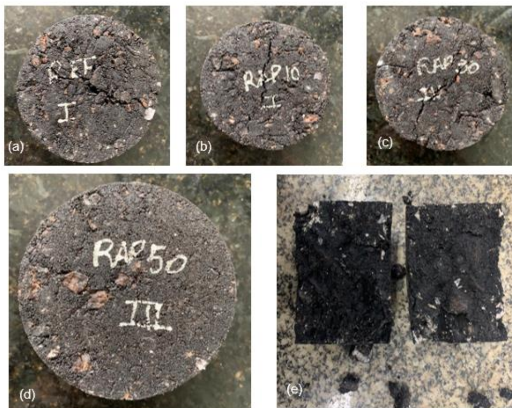
Figura 38 - Corpos de prova rompidos após ensaio de tração por compressão diametral, das misturas: (a) AREF; (b) ARAP10; (c) ARAP30; (d) e (e) ARAP50.
