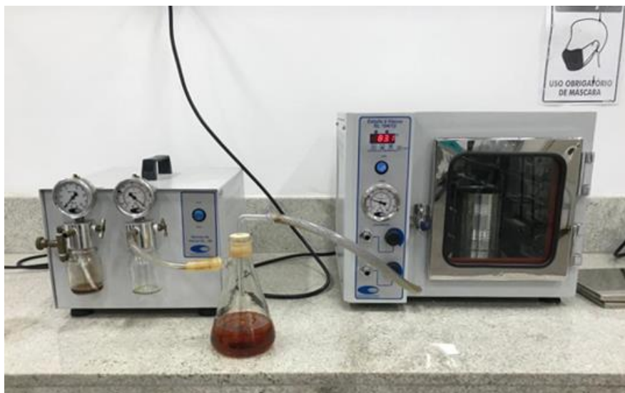
Figura 26 - Ligante recuperado por rotoevaporação em estufa a vácuo
