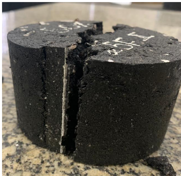
Figura 47 - Ruptura do corpo de prova
