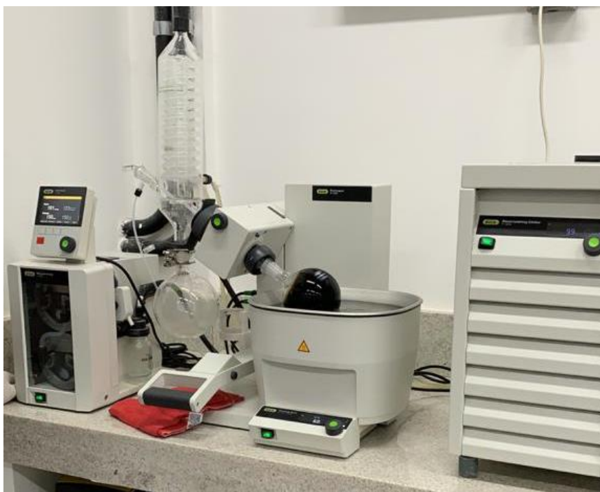
Figura 26 - Ligante recuperado por rotoevaporação em estufa a vácuo
