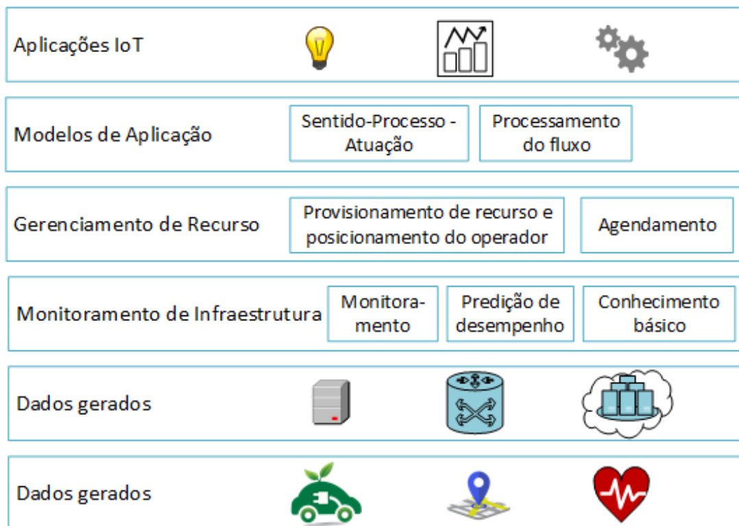
Figura 13 – Diagrama da arquitetura do iFogSim proposta por Gupta et al [29].
