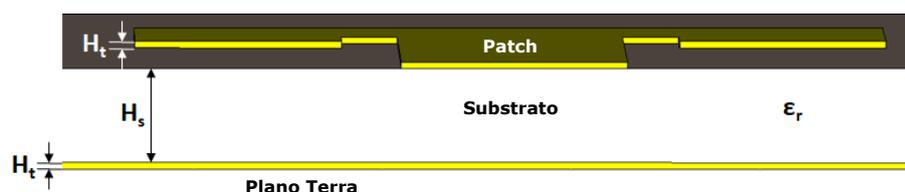
Figura 3.8: Visão em perfil de uma antena em microfita com *patch* retangular.
