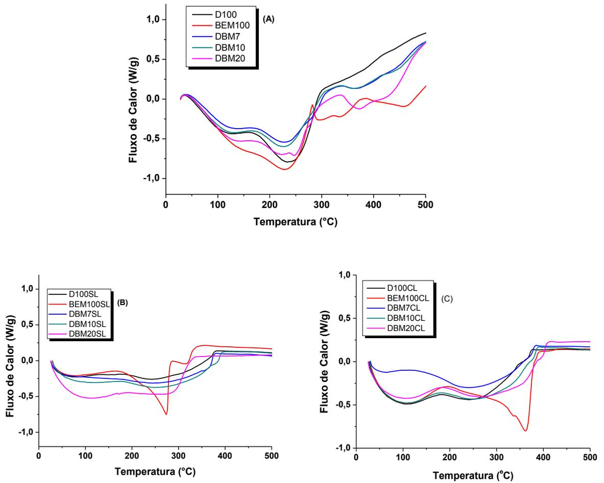
Tabela 7 Dados das Curvas de DSC correspondentes ao Diesel (D100), Biodiesel de óleo de Moringa (B100M), e de suas misturas nas proporções de 7, 10 e 20 % (v/v) de biodiesel ao diesel, início do armazenamento por 04 (quatro) meses, e seu término sem e com exposição à luz
