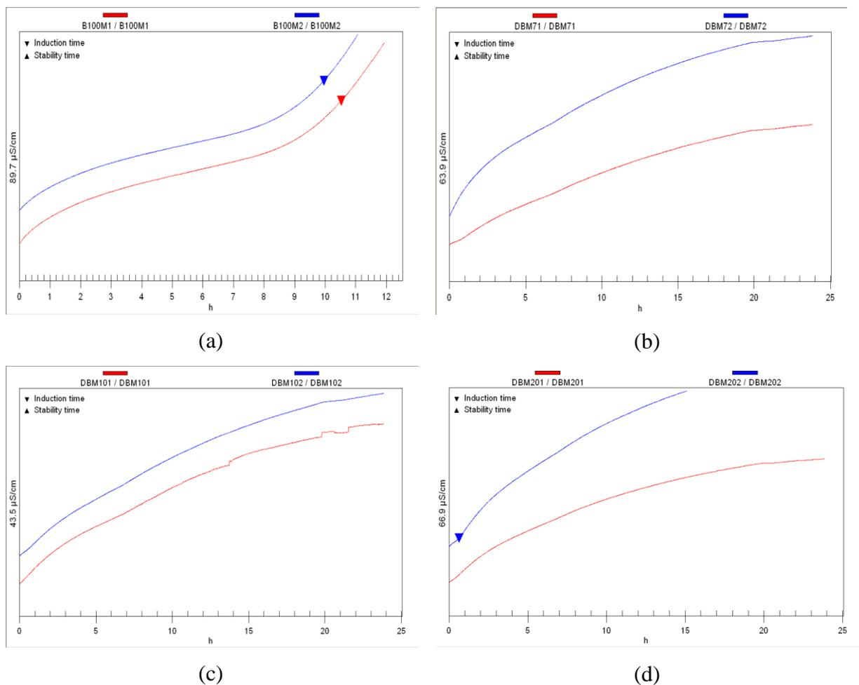
Pode-se observar, que a estabilidade oxidativa tanto do biodiesel de moringa (10,2 h, Figura 3a), como para as suas misturas DBM7, DBM10 e DBM20 (todas com PI >25 h, Figura 3 (b-d), respectivamente), apresentaram PI acima do limite estabelecido pela Resolução nº 45/2014 da ANP, que é de mínimo de 6 horas.
