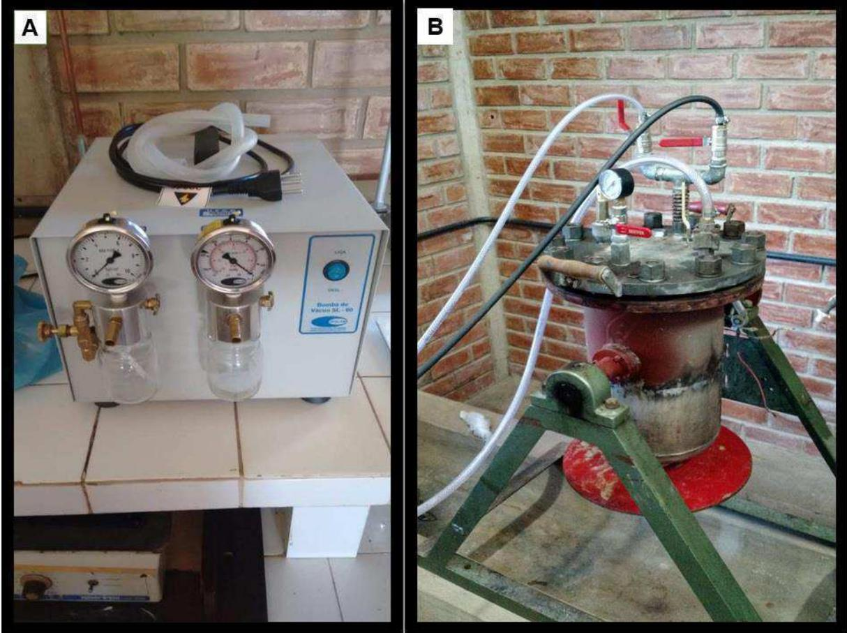
Sendo: A = Bomba de vácuo-pressão; B = Autoclave piloto.
