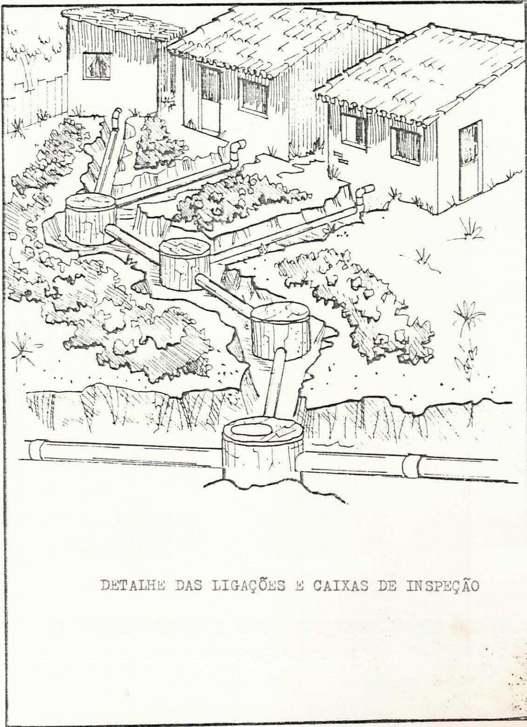
DETALHE DAS LIGAÇÕES E CAIXAS DE INSPEÇÃO
