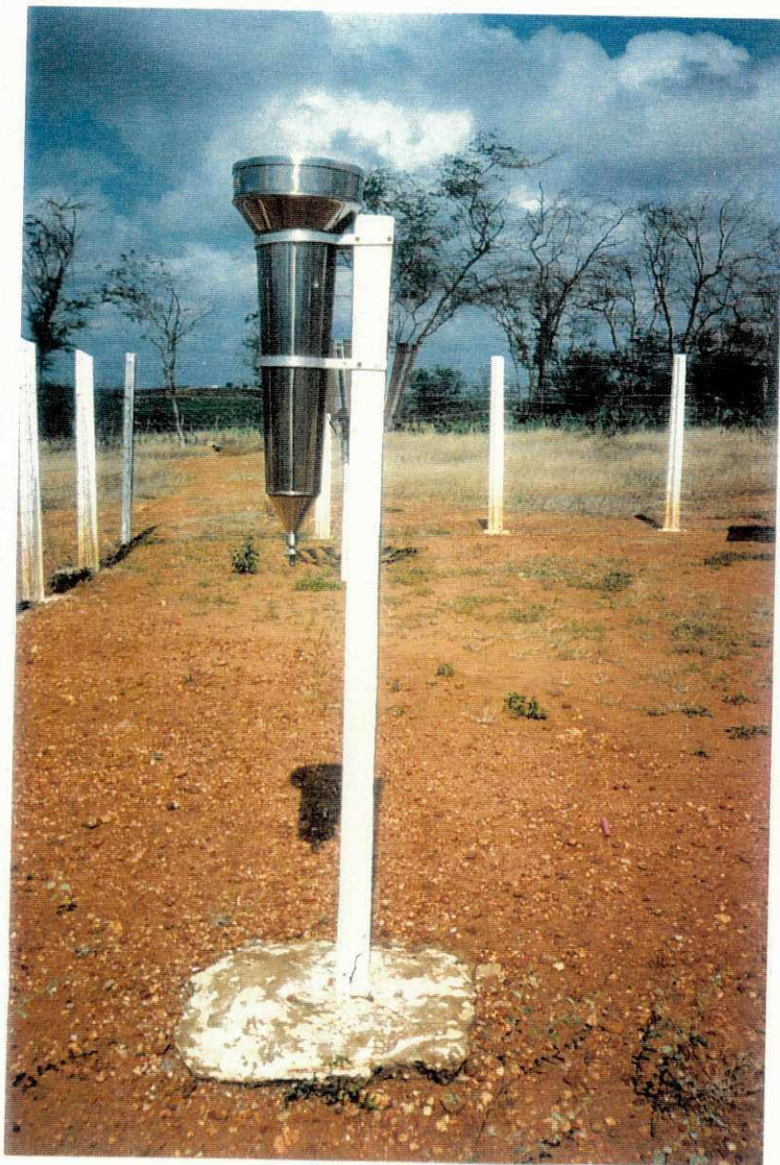
FIG. 1 - Pluviômetro Ville de Paris
