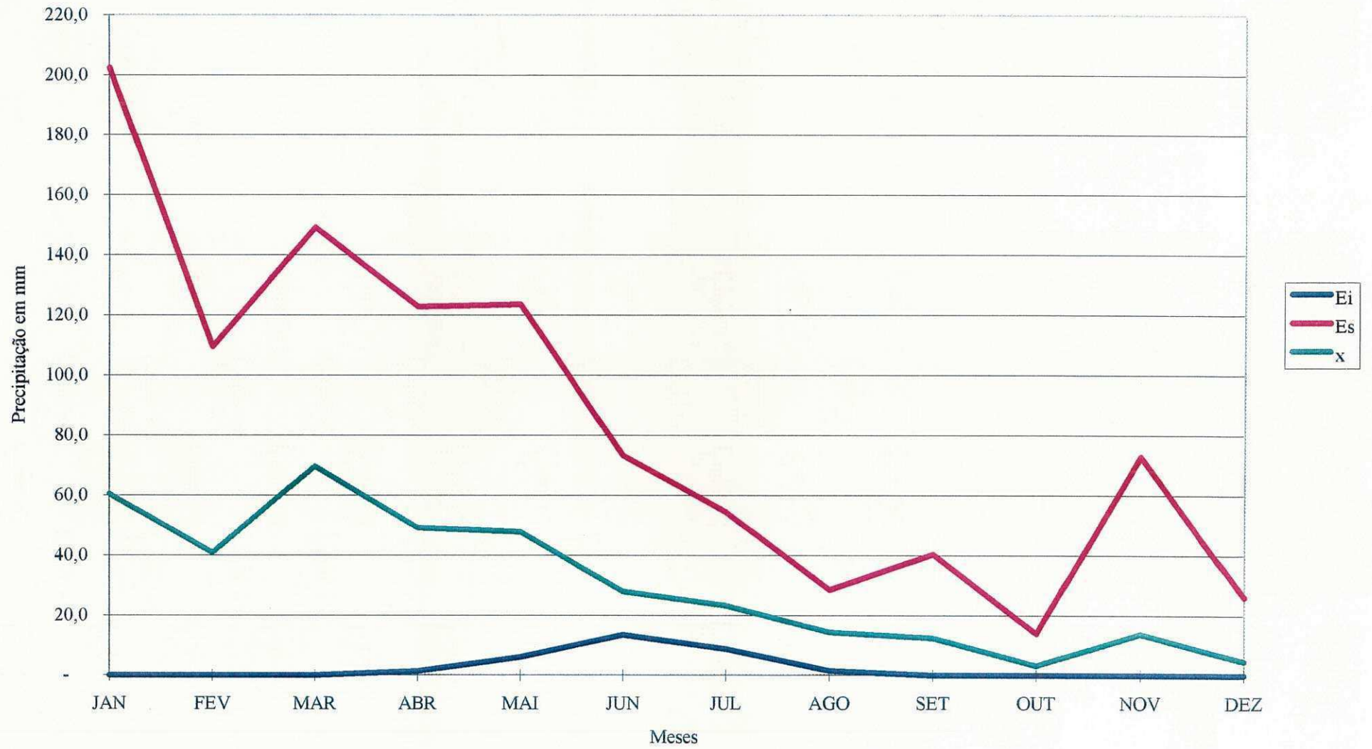
Pluviograma das Alturas Máximas, Médias e Mínimas Mensais Posto de São João do Cariri
