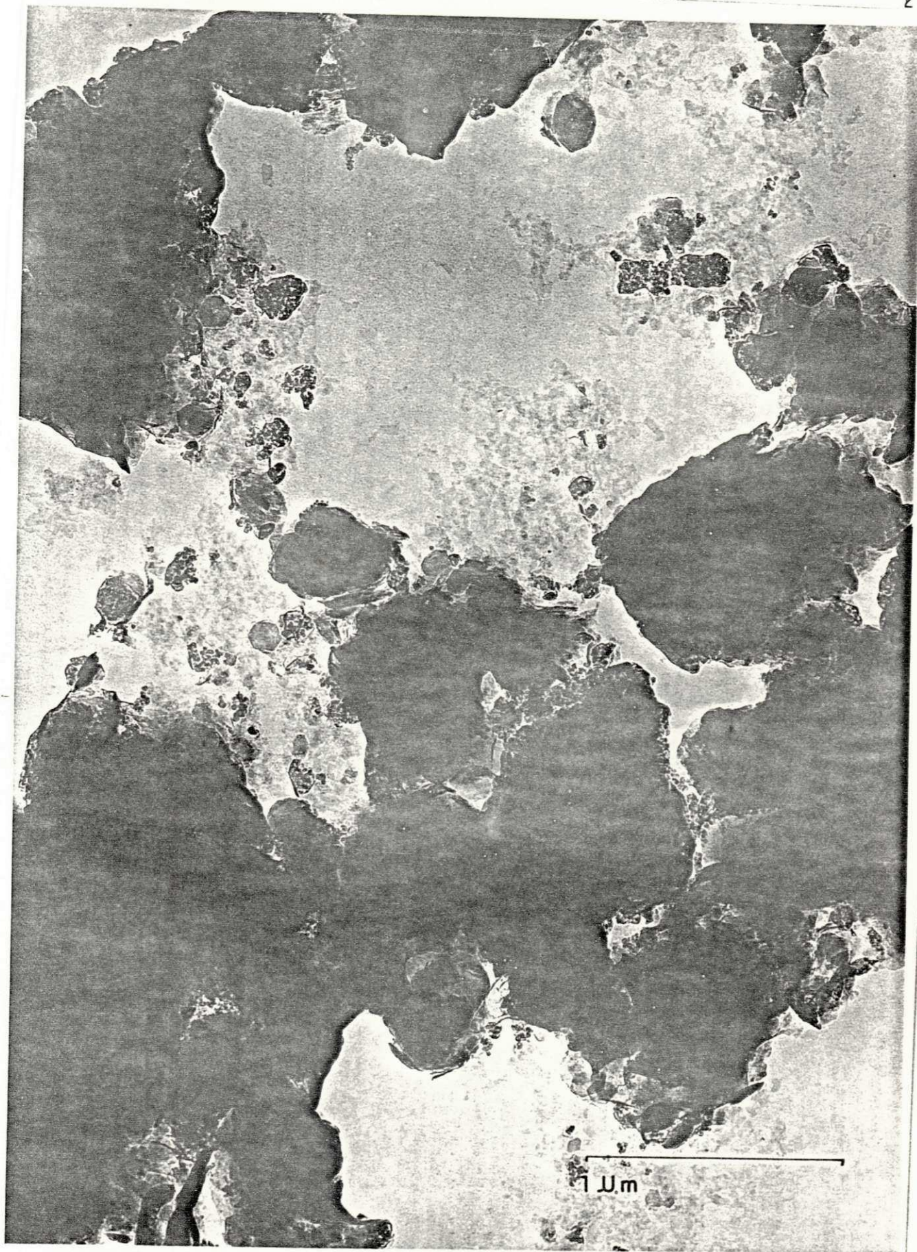
Figura D:- Micrografia Eletrônica de Transmissão da Argila de Cor Marrom Clara (Bofe), 49.000 X
