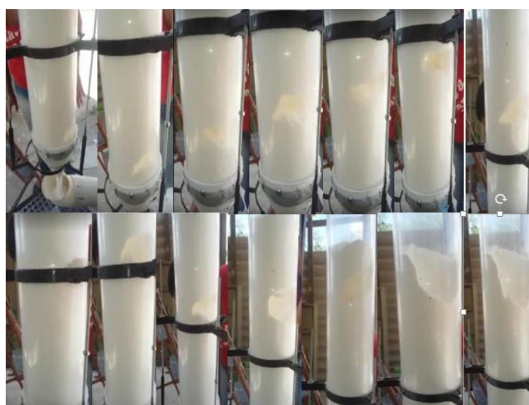
Figura 24 - Sequência de imagens para o açúcar confeiteiro com orifício de 0,030m
