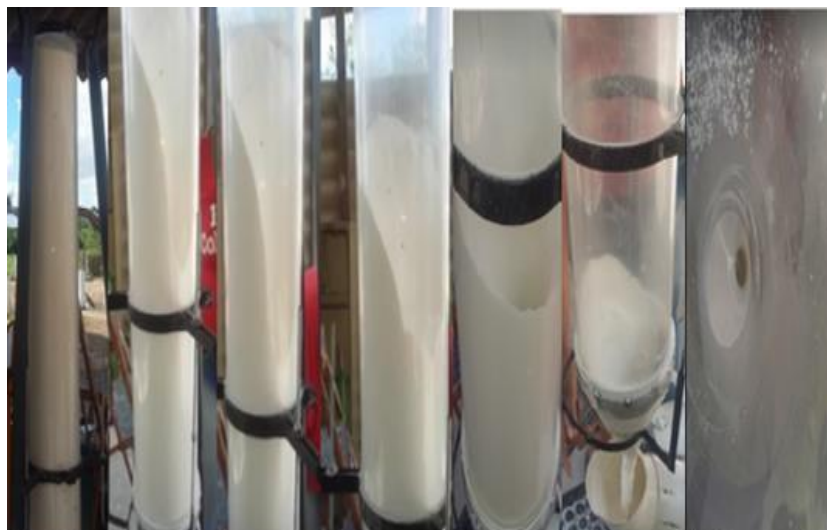
Figura 23 - Sequência de imagens para o açúcar confeiteiro com orifício de 0,085m
