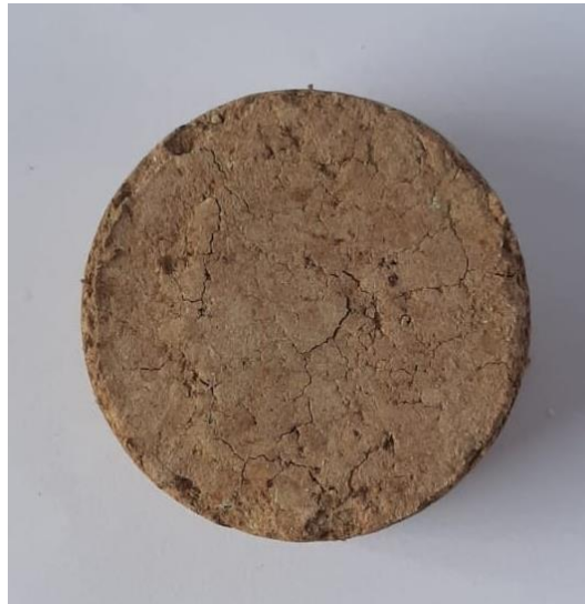
Figura 46 - Vista superior da mostra (50mm x 20mm)
