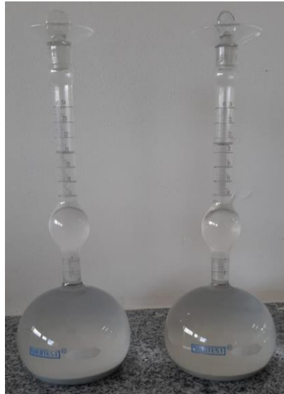
Figura 37 - Massa específica do PET (frasco volumétrico de Le Chatelier)
