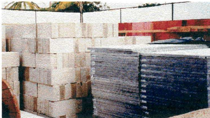
Foto 14 – Depósito da J.A.G., laje tipo wall à direita e bloco de sical à esquerda
