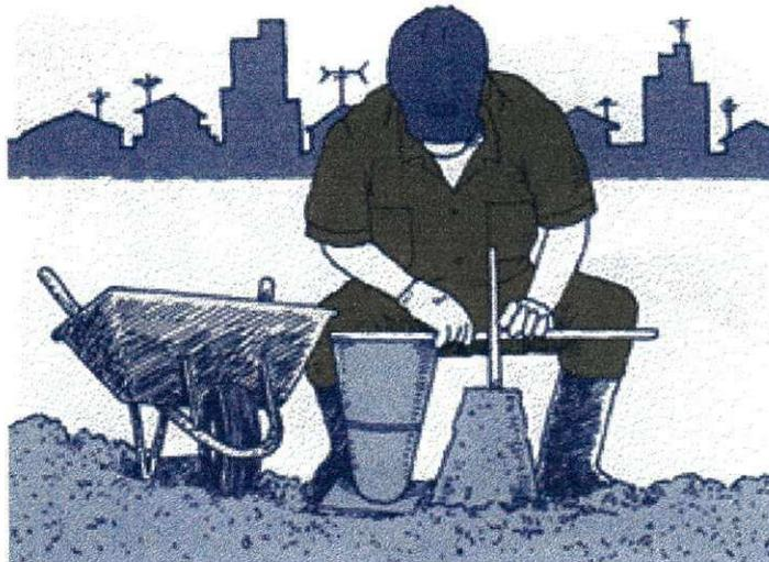
*Execução do Slump-Test na Obra*
