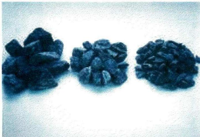
*Figura 1 – Forma Lamelar de um agregado graúdo*
